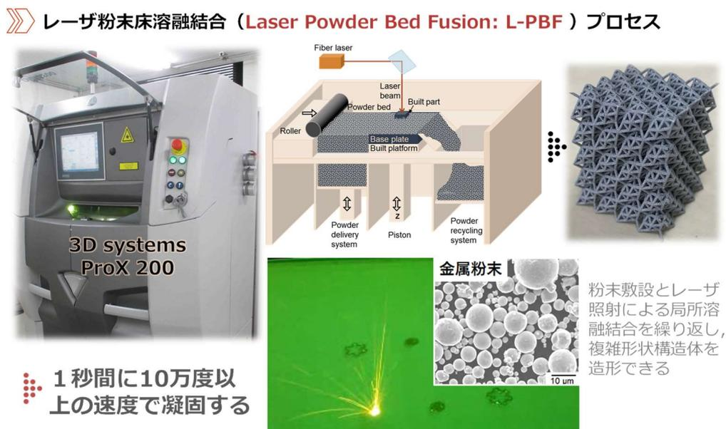
図 1 レーザ粉末床溶融結合 (Laser Powder Bed Fusion: L-PBF) 法の概要と本プロセスにより積層造形される複雑形状アルミニウム構造体 (Reference : X. Liu, A. Suzuki, N. Takata, M. Kobashi, M. Kato: Scripta Materialia **202**, (2021), 114003)
